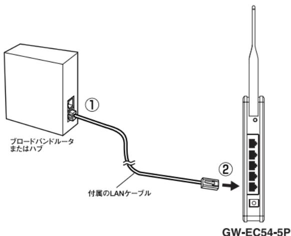
図2-2 GW-EC54-5P ネットワーク機器との接続
