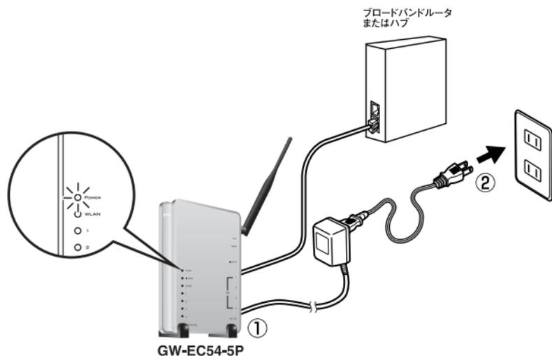
図2-3 GW-EC54-5P 電源の接続
