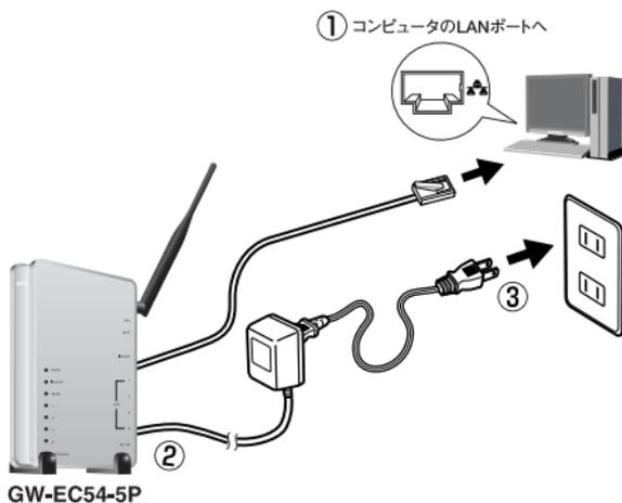
図3-1 GW-EC54-5P 機器の接続
