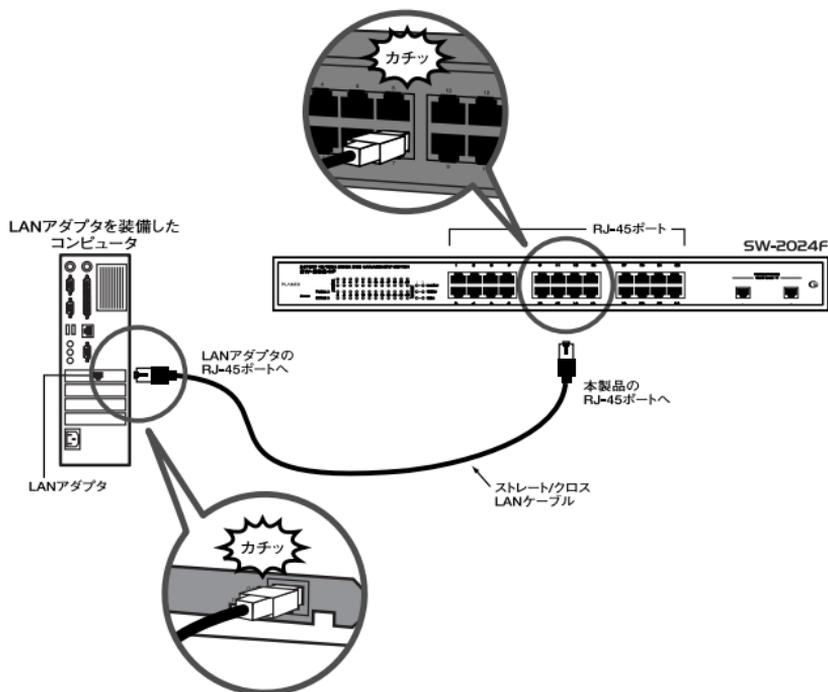
図2-5 RJ-45ポートを使用した接続
