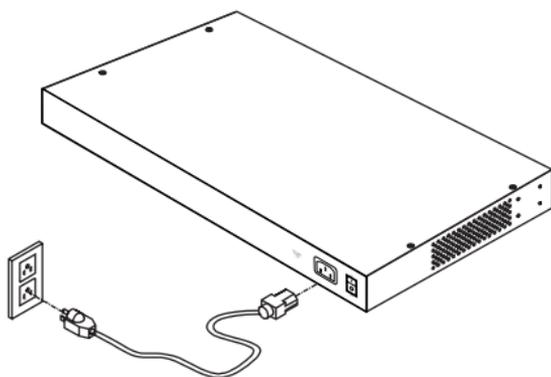
図2-4 電源ケーブル接続方法
