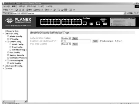
図3-22 リンク状態変更時のトラップ送出の設定(WEB)
