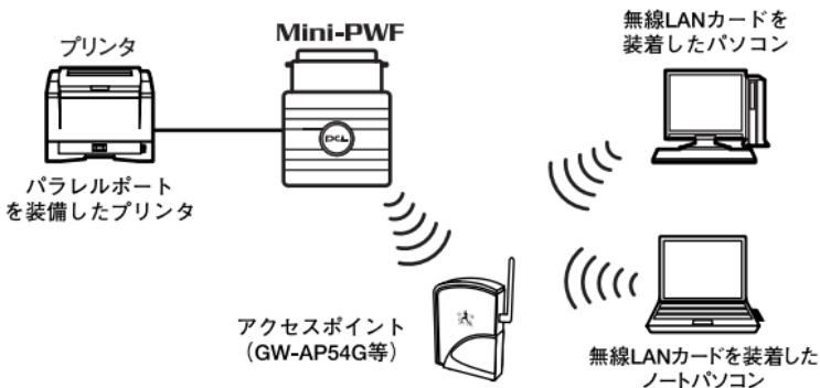
図4-1 インフラストラクチャモード
