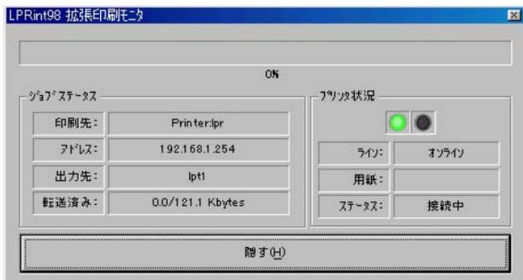
**注意** 「6.7.3.」のポートの詳細設定で「プリンタのステータスを監視する」をチェックしている場合のみ、信号の表示、オンライン/オフライン、用紙の各項目が表示されます。 ECP/Nibbleモードで印刷している場合は、オフライン情報/紙切れ情報は取得できません。また、プリンタによっては、オフライン情報/紙切れ情報を取得するのに必要な信号を出力しないものがあります。
