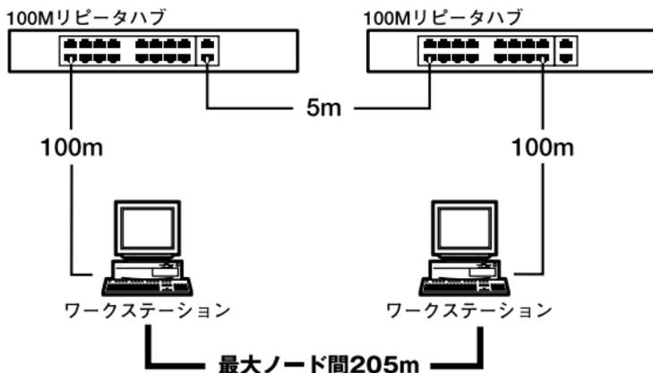
図C-1 100BASE-TXでのカスケード接続の制限
