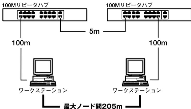
図4-5 100BASE-TXでのカスケード接続の制限
