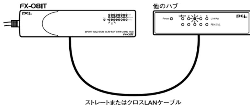
図3-6 カスケード接続時のLink/Act LED点灯図
