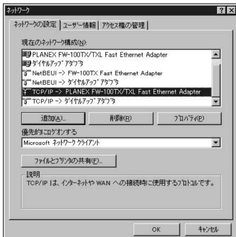
3.全ての設定が終了したら「ネットワーク」のプロパティの[OK]ボタンをクリックします。コンピュータを再起動するか聞いてきますので「はい」をクリックしてコンピュータを再起動してください。WindowsのインストールCD-ROMを要求するウインドウが表示される場合は、WindowsインストールCD-ROMをCD-ROMドライブにセットしてください。
