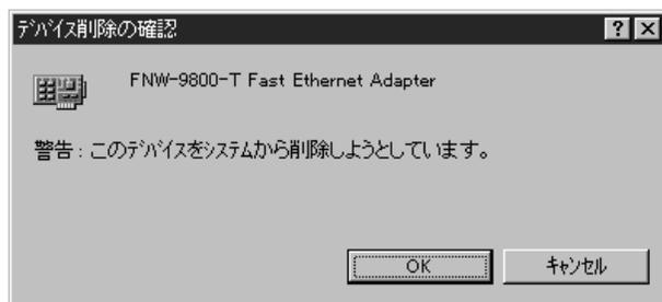
3. コンピュータの電源を切り、本製品をコンピュータから取り外して下さい。
