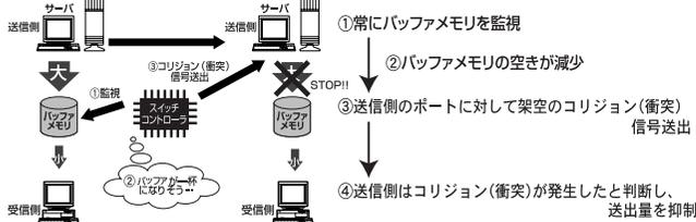
図 1-4 バックプレッシャーのしくみ
