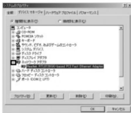
「ネットワークアダプタ」の下に「Realtek RTL8139(A)-based PCI Fast Ethernet Adapter」が表示されることを確認します。
