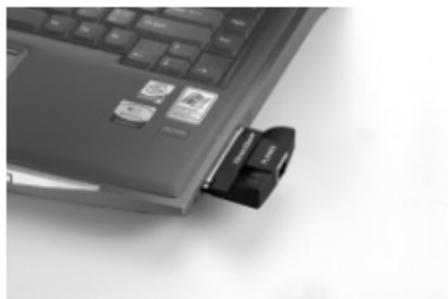
本製品が自動的に「Realtek RTL8139(A)-based PCI Fast Ethernet Adapter」として認識され、「新しいハードウェアの追加ウィザード」が表示されます。
