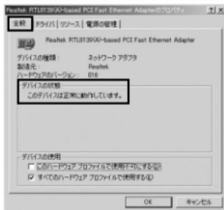
詳細設定は、プロパティ画面から変更できます。プロパティ画面を表示するには、「スタート」「コントロールパネル」「ネットワーク」「Realtek RTL8139 Family PCI Fast Ethernet NIC」を選び、[プロパティ] をクリックします。
