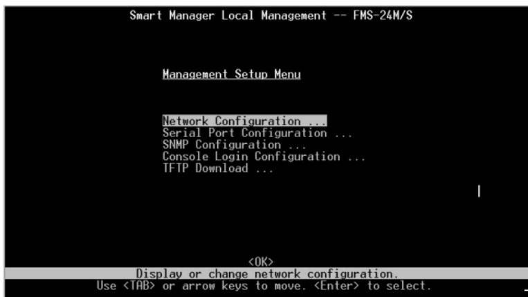
2. 「Management Setup Menu」メニューで、カーソルを「Console Login Configuration」に移動して[ Enter ]キーを押してください。「Console Login Configuration」メニューが表示されます。
