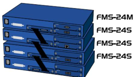
※FMS-24Sはスレーブハブですので、FMS-24S単体では動作しません。FMS-24Mにスタック接続してご使用ください。
