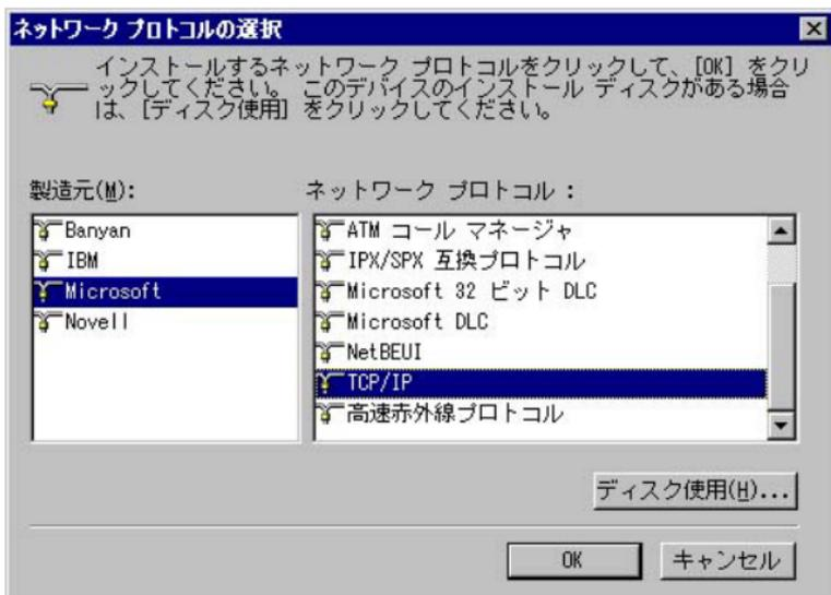
5. 「TCP/IP」を選択し「プロパティ」ボタンをクリックしてください。「TCP/IPのプロパティ」画面が表示されるので、「IPアドレス」タブをクリックしてください。画面内の「IPアドレスを自動的に取得」オプションを選択し、コンピュータを再起動してください。
