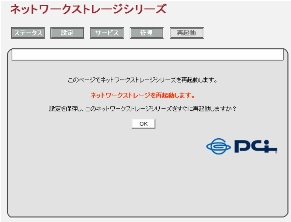
再起動はおよそ 60 秒で完了し、固定 IP アドレスで設定している場合には自動的にステータスのページが表示されます。
