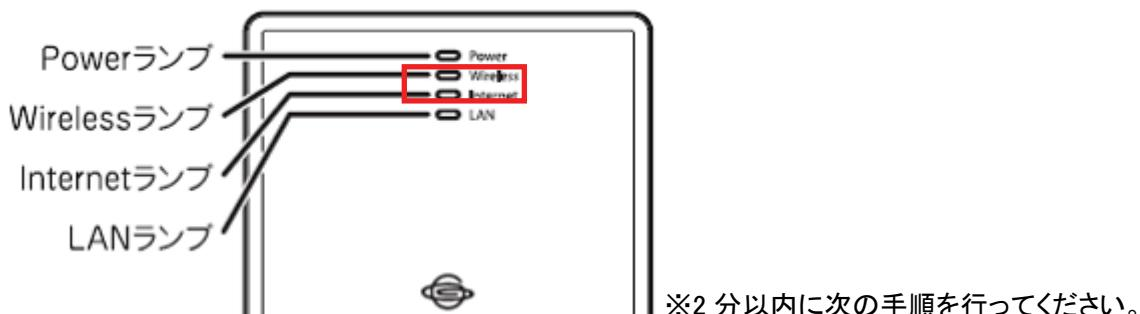
3. 接続が完了すると、「Wireless」ランプが再び橙色で点滅し、本製品が再起動します。
