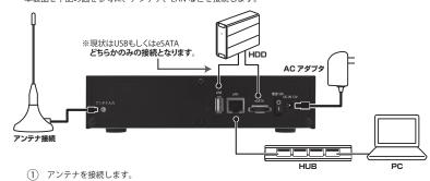
レコーダー本体の「アンテナ入力」に、付属のアンテナを接続します。 または、部屋に TV 視聴のためのアンテナ端子がある場合は、付属の F 端子変換ケーブルを使って 「アンテナ入力」に接続します。
