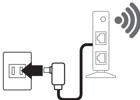
2) 本製品に AC アダプタを接続して電源を「ON」にします。
