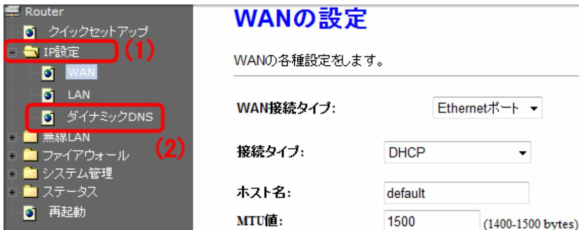
The screenshot displays the router's configuration interface. On the left, a sidebar menu lists various settings: クイックセットアップ, IP設定 (1), WAN, LAN, ダイナミックDNS (2), 無線LAN, ファイアウォール, システム管理, ステータス, and 再起動. The main area is titled 'WANの設定' and contains the following configuration options:
