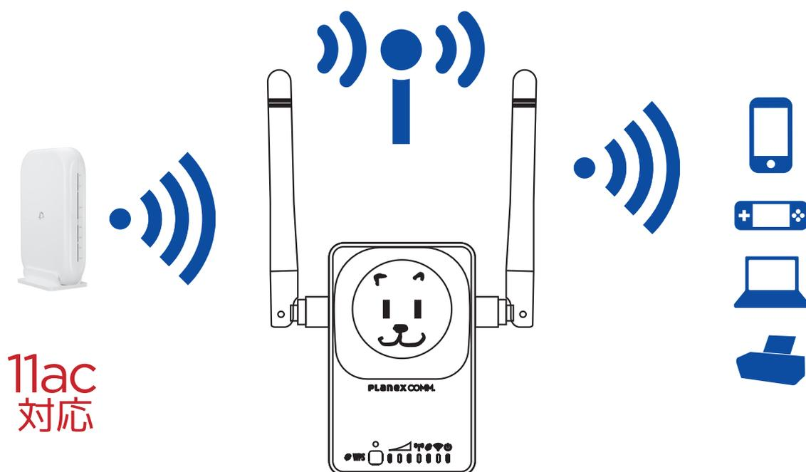
無線 LAN ルーターの電波をより遠くに飛ばして、電波の届かなかった場所に中継します。
