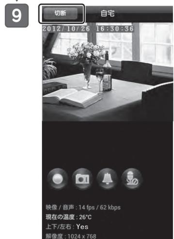
カメラの画像が表示されます。画面をフリックすると、パン・チルト動作します。終了する場合は「切断」をタップしてください。
