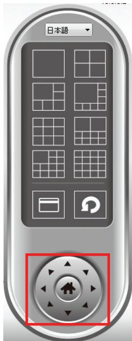
映像表示エリアで希望の映像をクリックしてカメラを選び、カメラを動かしたい方向に該当するボタンをクリックします(8 方向から選べます)。カメラの方向をホーム(初期設定)の位置に戻すには、「ホーム」(
