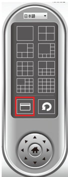
自動切換え機能を起動するには、[自動切換え]を1度クリックします([自動切換え]アイコンが青になります)。自動切換えを停止するには、もう一度クリックします([自動切換え]アイコンが白になります)。
