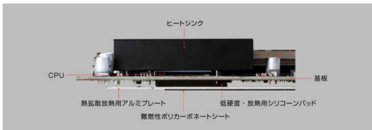
下面からの放熱は補助的な役割ですが、基板、低硬度・放熱用シリコンパッド、熱拡散放熱用アルミプレート、難燃性ポリカーボネートシート、筐体下面の順に連続的に接触していますので、稼働時には筐体上面より筐体下面の方がほんのり暖かくなります。このため筐体下面に貼るゴム足は通常より高さのあるものを採用し下面からの放熱のために隙間を確保しています。
