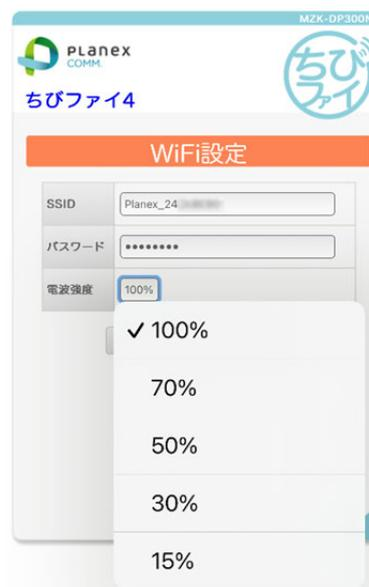
電波強度を下げると通信速度は遅くなりますが、「ちびファイ4」の利用シーンでは、「ちびファイ4」とデバイスの距離が極めて近いいため、実測すると速度低下は微減で、オンライン会議や動画再生は可能と思われます。十分な通信速度が保てる範囲で電波強度を下げれば、室外への電波漏れが減少、外部から「ちびファイ4」の存在も見えにくくなります。
