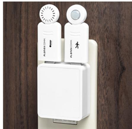
「どこでも環境センサー」は気温、湿度、気圧のデータを常時計測、「どこでも人感センサー」は赤外線検知により人や動物の接近を常時検知し、計測値や検知した回数をクラウドに保存します。
