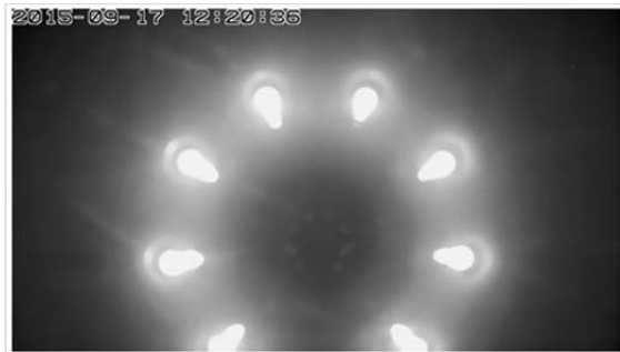
【赤外線を照射する暗視カメラの反射例】
