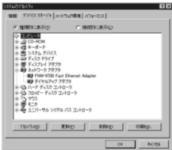
表示されない場合はドライバが正常にインストールされていない可能性があります。もし「その他のデバイス」が存在し、その左の[+]マークをクリックしたときに「PCI Ethernet Controller」が「FNW-9700-T Fast Ethernet Adapter」が表示される場合はこれを選択し[削除]ボタンをクリックしてください。
