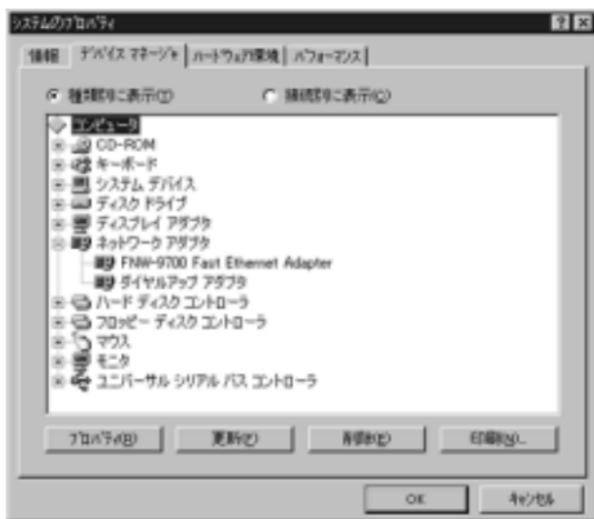
ネットワークアダプタの下に「FNW-9700-T Fast Ethernet Adapter」が表示されない、またはアイコンに「？」や「！」のマークが表示される場合はドライバのインストールが正常に終了していません。3-5の手順でドライバを一旦削除してから3-2または3-3の手順で再度インストールしてください。
