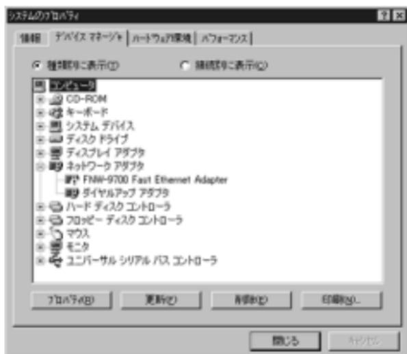
3. 「FNW-9700-T Fast Ethernet Adapter」を選択して[プロパティ] ボタンをクリックしてください。プロパティ画面の「デバイスの状態」で「このデバイスは正常に動作しています。」というメッセージが表示されればドライバのインストールは成功です。
