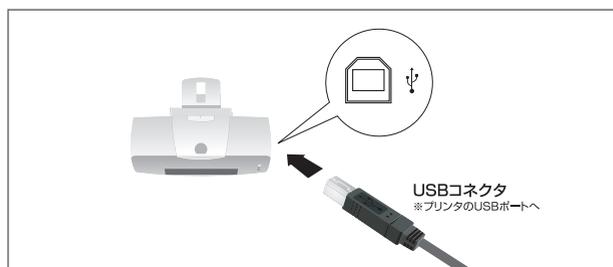
2 USBケーブルのもう一端を本製品のUSBポートに取り付けます。
