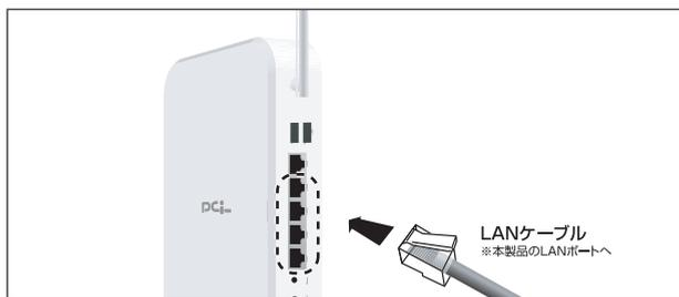
**4** LANケーブルのもう一端をコンピュータのLANポートに接続します。
