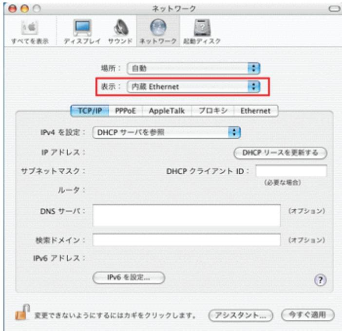
※[DHCP サーバを参照]が表示されていないときは、[PPPoE]タブをクリックし、「PPPoE を使って接続する」のチェックをオフにします。
