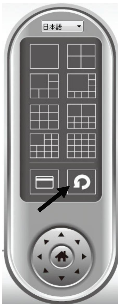
自動切換え機能を起動するには、[自動切換え]ボタンを1度クリックします([自動切換え]アイコンが青
