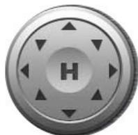
カメラの方向を動かします。8 方向のボタンのいずれかを押して、カメラの動く方向を変更します。「H」ボタンを押すと、カメラをホーム(元)の位置に戻します。
