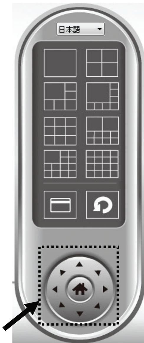
映像表示エリアで希望の映像をクリックしてカメラを選び、カメラを動かしたい方向に該当するボタンをクリックします(8方向から選べます)。カメラの方向をホーム(初期設定)の位置に戻すには、「ホーム」ボタン(🏠)をクリックします。
